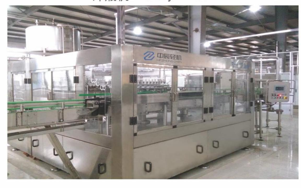
温瓶机通常用于冷灌装生产线的饮品在生产线之 中,灌装后在保证饮品色、香、味以及营养成分不变 的情况下用提高瓶温的方法减少饮品与室温环境的温 差,消除瓶子外表面的冷凝水,便于贴标、装箱等工 序。该产品常用于汽酒包装生产线。
